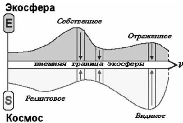
Рис. 2. Модель распределения энергии в спектрах космической и земной радиации: E, S – земное и космическое излучения, соответственно; \nu – частота
